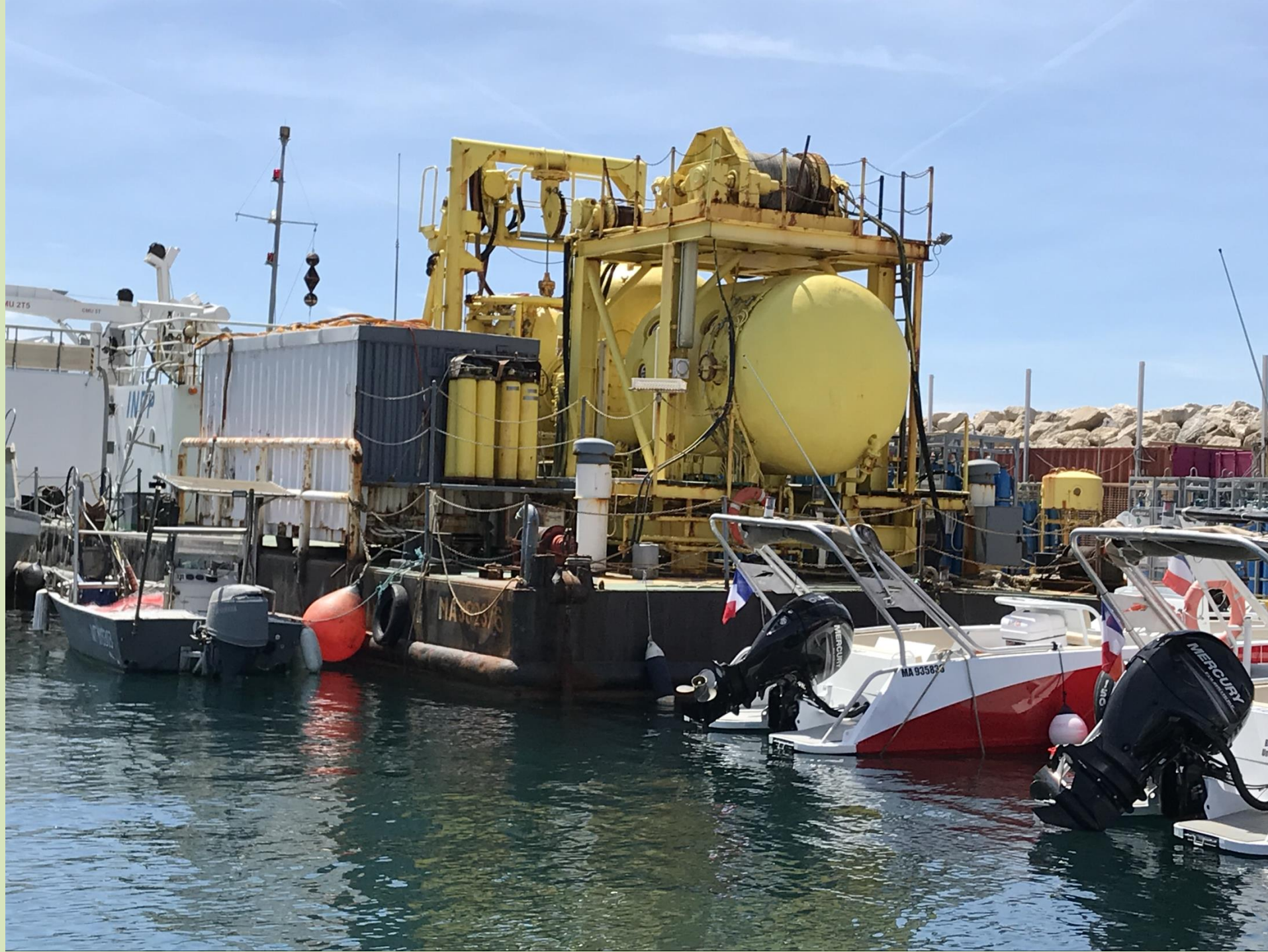
Гипербарическ ий Комплекс для работы в насыщающем режиме в порту Марселя
