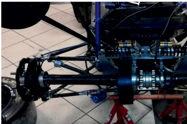
**Рис. 12.** Гоночный автомобиль с установленными композитными приводными валами последней конфигурации
