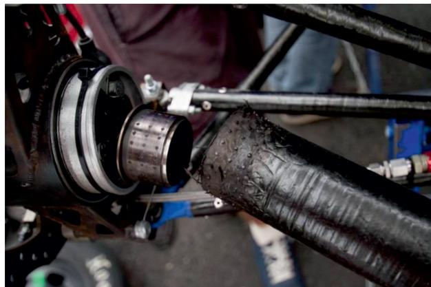
Рис. 10. Разрушенный композитный приводной вал
