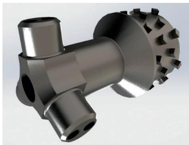
Рис. 11. Наконечники валов с ромбовидными соединительными элементами
