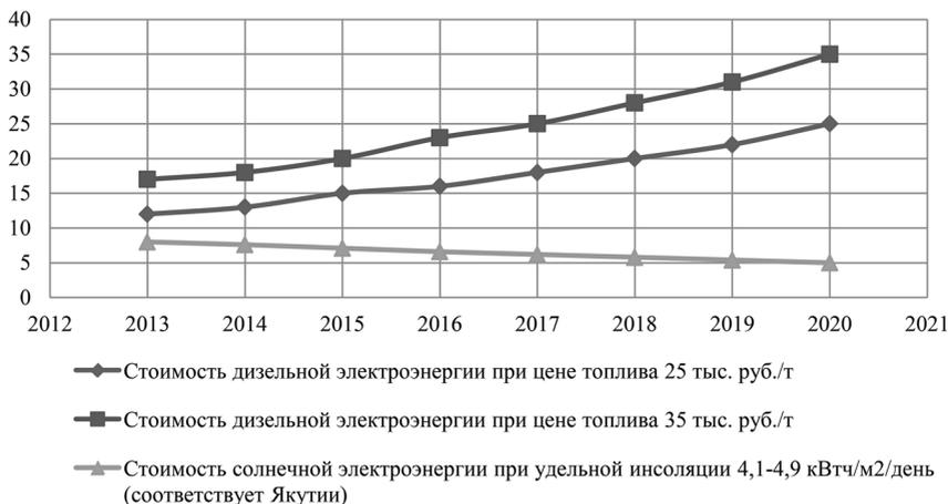
*Рис. 1. Сравнение стоимости кВтч солнечной и дизельной электроэнергии*
