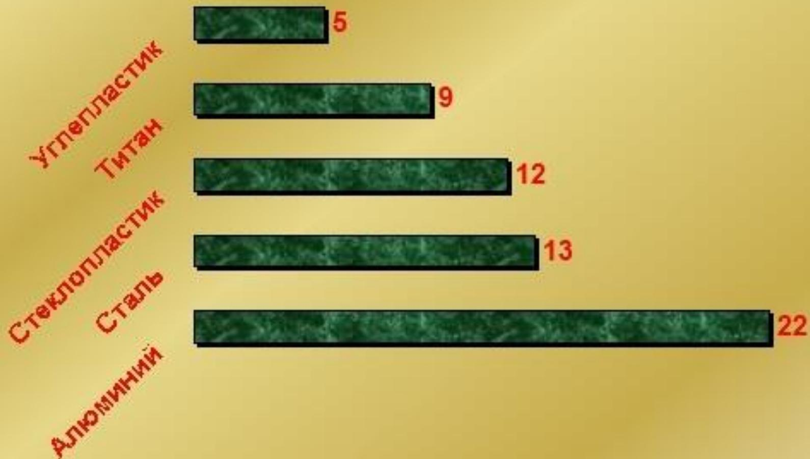
Разрушающее напряжение при растяжении, МПа
