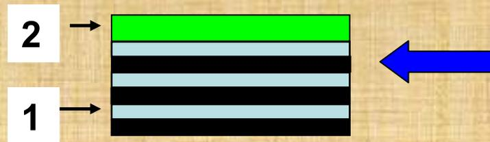
i) На поверхность материала 1 (полупроводник, диэлектрик, металл или сверхпроводник) наносится тонкий слой фоторезиста (полимера) 2.
