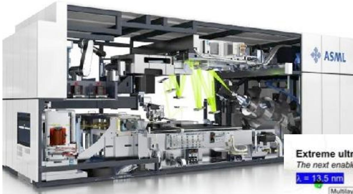
EUV генерируется в плазме, создаваемой при испарении микрокапель сверхчистого олова пучком CO<sub>2</sub> лазера
